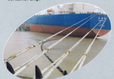
首艘“VLCC”全球首次使用超高分子量聚乙烯绳替代钢绳 "VLCC" used POWERNEEMA™ Rope instead of wire rope.
